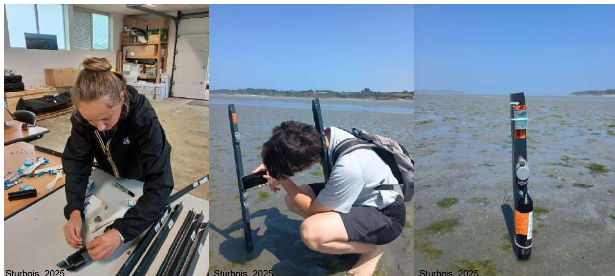
Figure 13. Mise en place du suivi de température dans le sédiment
