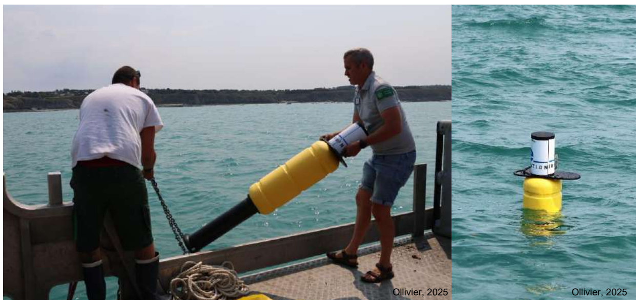
Figure 14. Installation de la sonde multiparamètre en zone proche subtidale avec l'aide des mytiliculteurs
