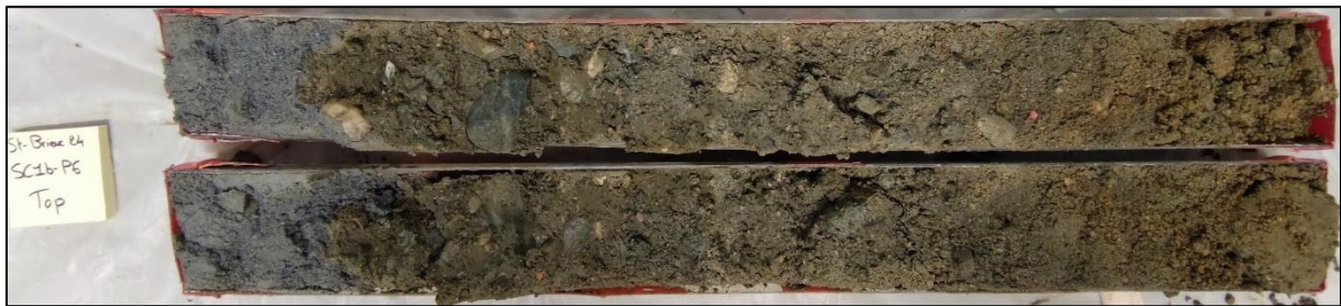
Figure 15: Photographie du carottages SC1b, section 6, après ouverture.
