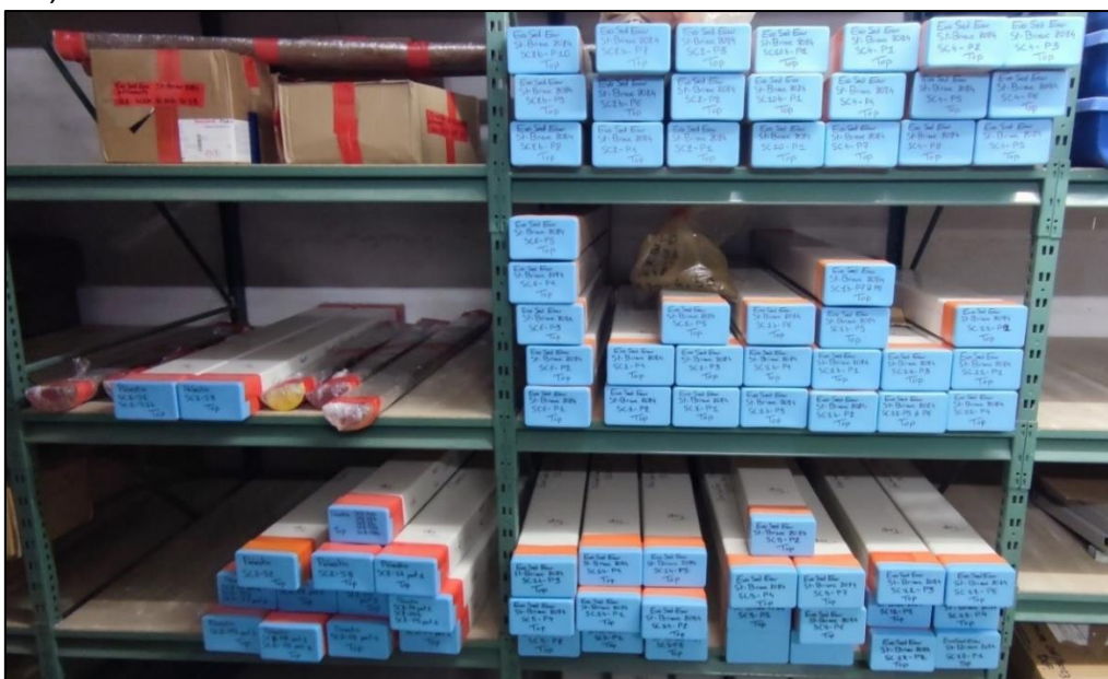
Figure 19: Stockage des sondages conservés dans des tubes rigides.
