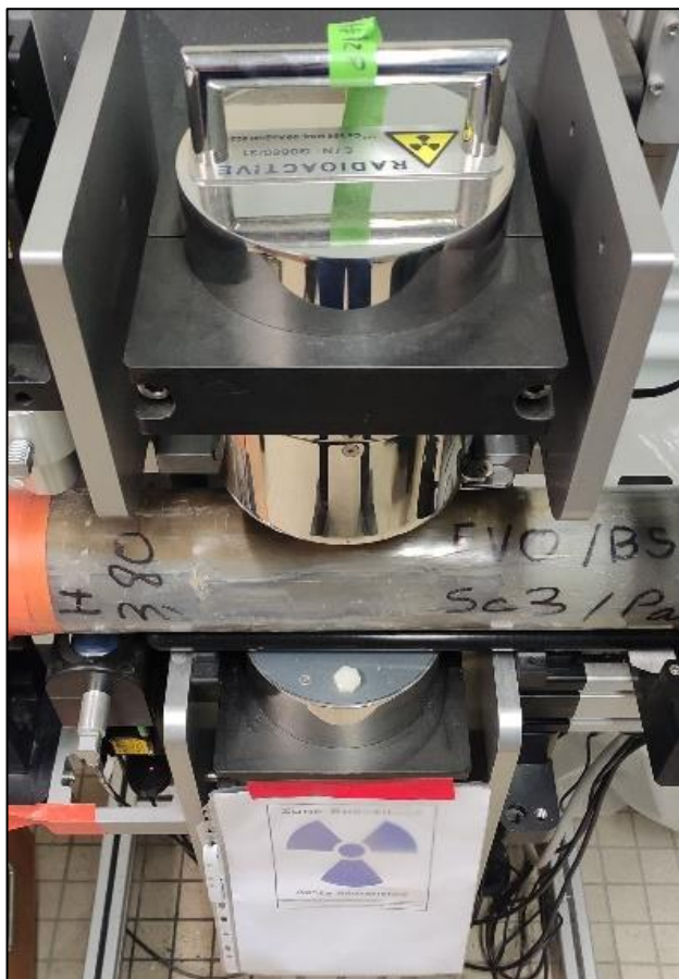
Figure 7: Source de Césium 137 (en haut) et détecteur du rayonnement gamma (en bas) du MSCL
