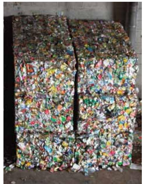
Les canettes en aluminium sont pressées sous forme de pavés, appelés balles.
