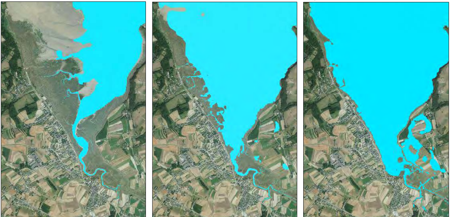
Fig. 1.3- Cartes de variation des hauteurs d'eau dans le marais (9,4 m ; 10,6 m ; 12 m)
