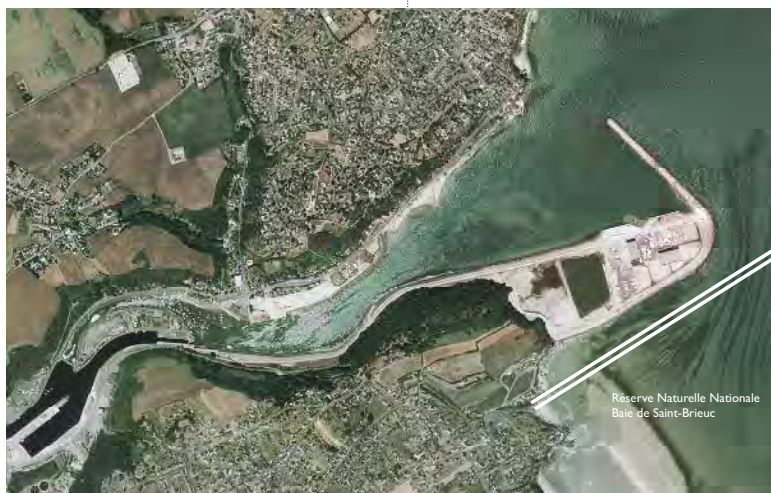
Extension du port de Saint-Brieuc avec la création d'un enrochement en 1985 et d'une digue perpendiculaire en 2000.
