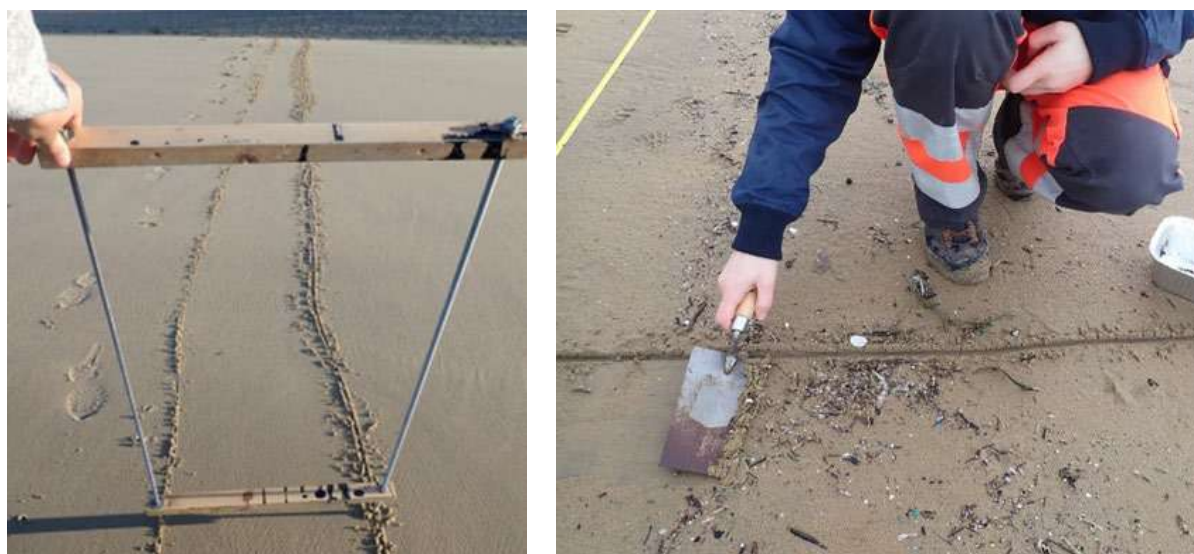
Figure 3 : (a) Traçage d'une bande de 50 cm de large avec l'outil fabriqué par le Cedre. (b) Prélèvement de microplastiques échoués (source : Cedre).
