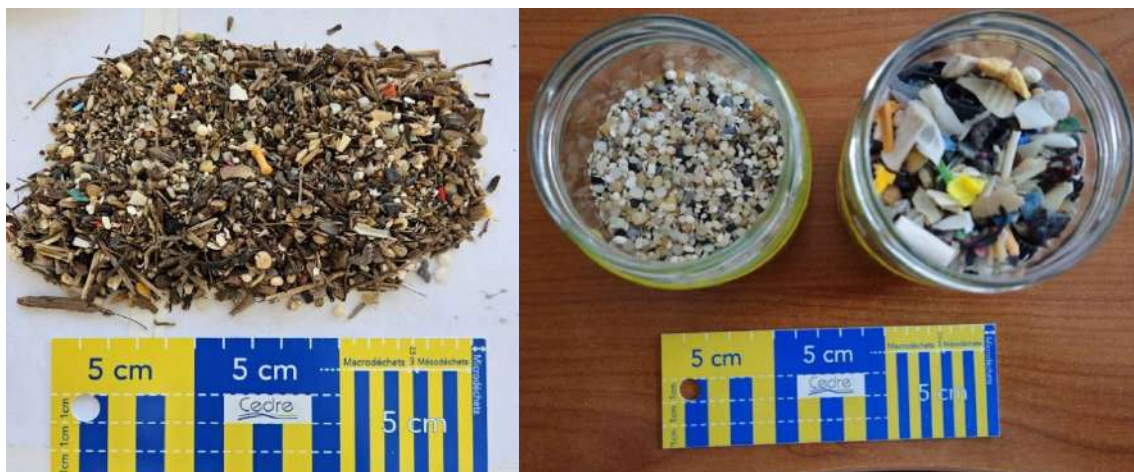
Figure 4 : (a) Échantillon contenant de la matière organique avant tri. (b) Échantillon nettoyé avec les grands microplastiques à gauche et les mésoplastiques à droite (source : Cedre).
